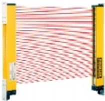
B800/104 , Sicherheits-Lichtvorhang BLVT Kat.4 mit Blanking, Mindest-Hindernisgrösse 14mm.
